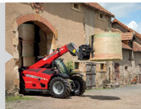
Deux positions de cabine pour une polyvalence optimale, avec notamment une position basse pour le chargement dans les bâtiments de faible hauteur. Parfait pour les travaux dans des espaces restreints. Grâce à leur design compact, ces modèles peuvent circuler dans des zones très étroites, sans perte de visibilité et de maniabilité.
