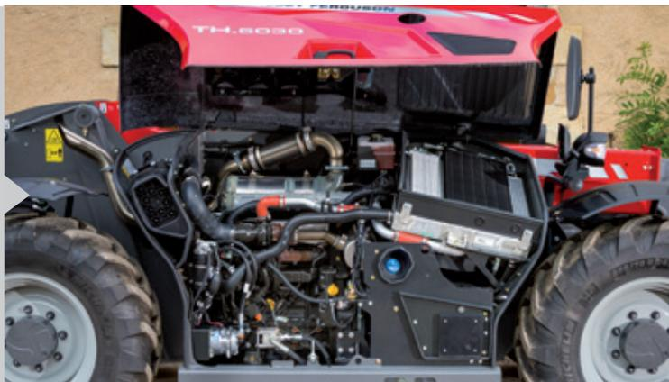
Le filtre à air se retire facilement pour le contrôle et le nettoyage. Un ventilateur à inversion automatique est disponible en option si nécessaire. Il vous suffit d'appuyer sur le commutateur ou de régler l'activation automatique pour que le ventilateur inverse son cycle, chassant ainsi toutes les poussières, bris de paille et autres matières éventuellement collées sur le circuit de refroidissement.
