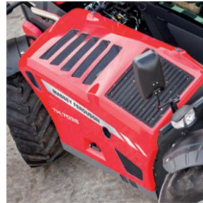
La nouvelle implantation du moteur et la conception de son berceau réduisent la hauteur de l'ensemble pour une meilleure visibilité du côté droit. Avec un capot renforcé et une plus grande ouverture, les modèles MF TH bénéficient également d'un nouveau système de poignée pour l'ouverture du capot.
