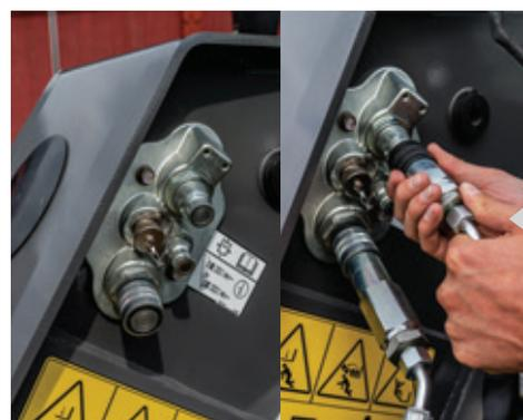
La connexion et la déconnexion sont simples grâce au bloc connecteur et à son système de libération de pression. Pour les outils plus exigeants tels que les diffuseurs de paille et les godets désileurs, une ligne électrique peut être ajoutée pour offrir une 4<sup>e</sup> et une 5<sup>e</sup> fonctions.
