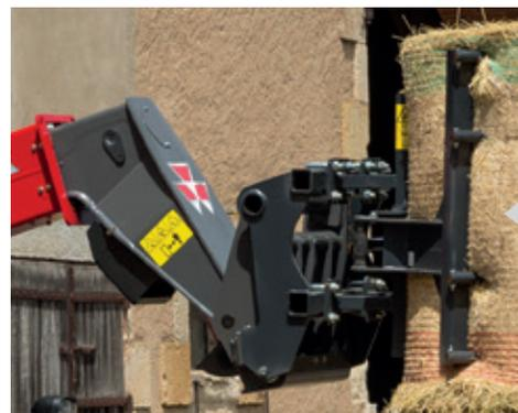
Des raccords rapides à libération de pression intégrés sont montés sur la tête de la flèche pour un montage et un démontage rapides, efficaces et faciles des outils.
